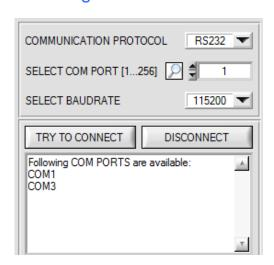
Durch Drücken auf die Lupe in der Registerkarte **CONNECT** werden alle verfügbaren **COM PORTS** aufgelistet.
